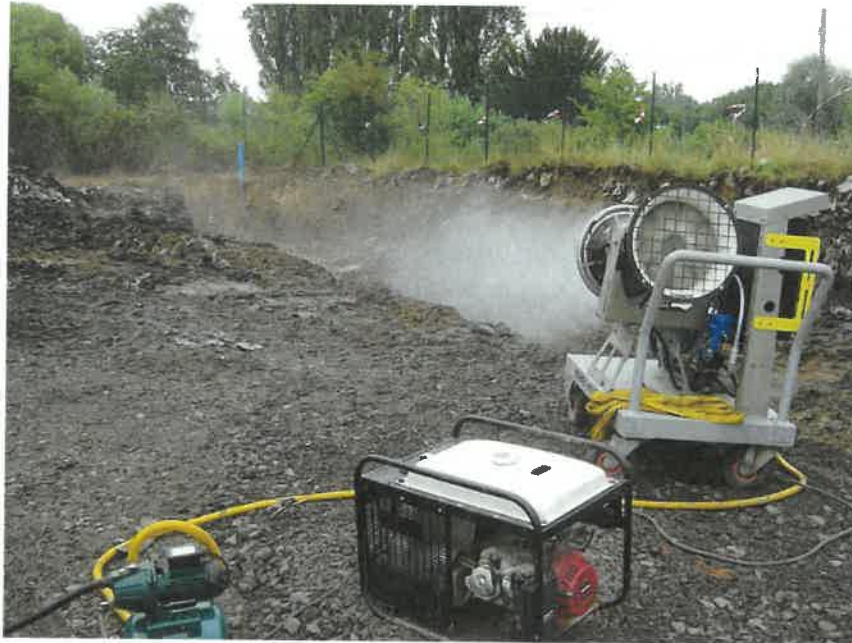
Figure 7 : système de neutralisation des odeurs (spraystream trolley 20)
